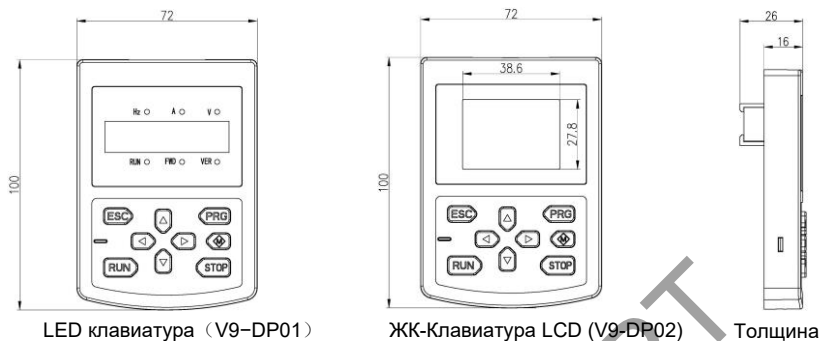
Рисунок 1-3 Внешний вид клавиатуры и монтажные размеры
